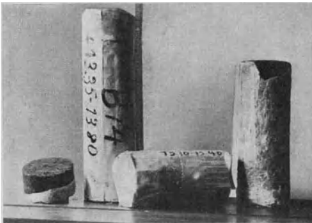
Abb. 7. Ungestörte Bodenproben aus dem Bohrloch.
