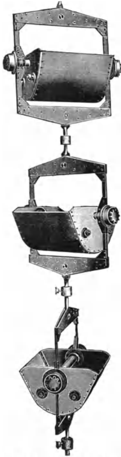
Fig. 91. Becherförderer (Conveyor) für senkrechte und spiralförmige Kurven.
