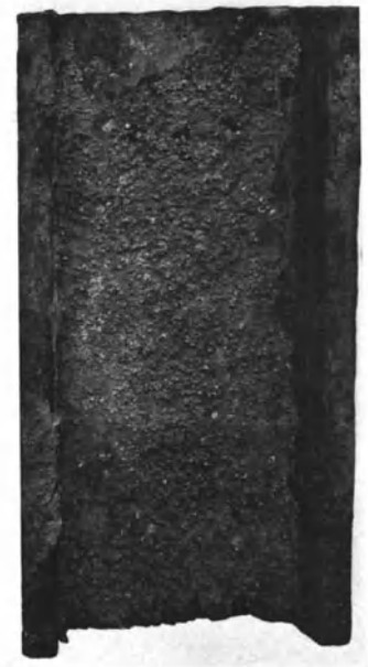
Bild 14. St 5510, Unterseite, nach 8 Jahren ganz im Wasser (Emden)
