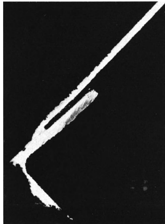
Bild 8. Zinkblechabdeckung von der Berliner Petrikerche. Alter wahrscheinlich 84 Jahre. Schnitt durch Blech und angelötetes Winkelstück
