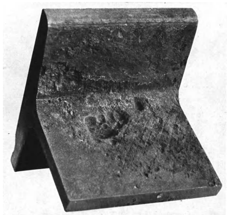
Bild 41. Anfrassungen unter der Holzverkeilung (bei NP 32 in Bild 36 und 37). * v = \text{lin. Vergrößerung} .
