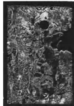
Bild 6. Von kohlenstoffarmem destilliertem Wasser zerstörte Zinkprobe (Versuchsdauer 92 Tage) 1 V = lin. Vergrößerung.
