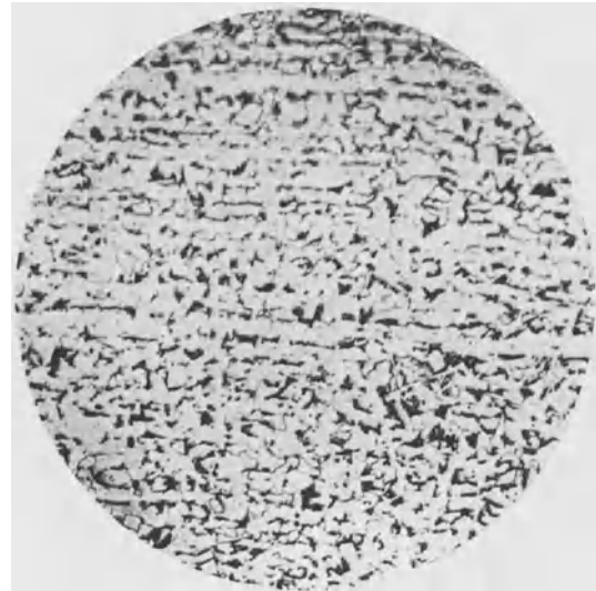
Bild 3 und 4. Gefüge eines Spundbohlen-Abschnittes aus St 37 03
