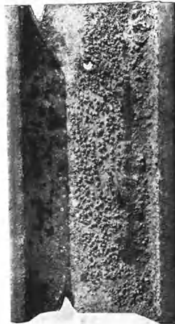
Bild 13. St 55, Unterseite, nach 2 Jahren ganz im Wasser (Emden)
