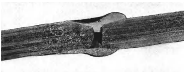
Bild 29. Geätzter Querschliff durch die Schweißung * v = \text{lin.} Vergrößerung.
