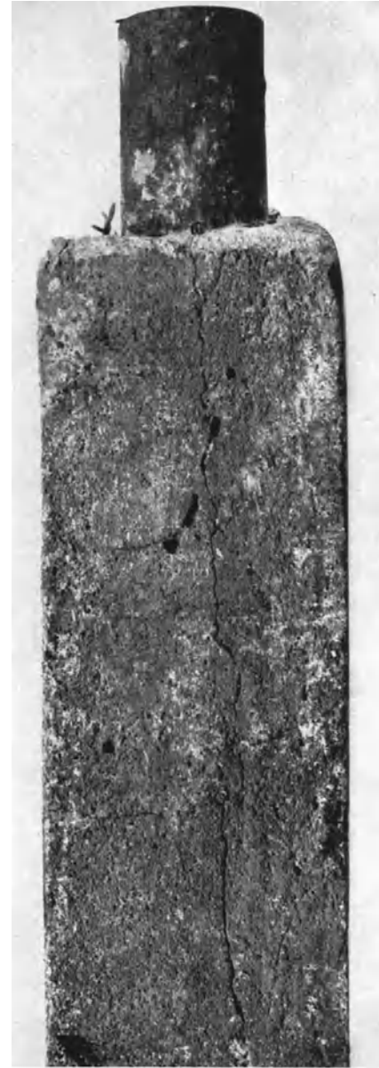
Bild 30. Rundeisenanker mit Beton-Ummantelung (Ummantelung oben entfernt) (Alter 45 Jahre). * v = \text{lin.} Vergrößerung.
