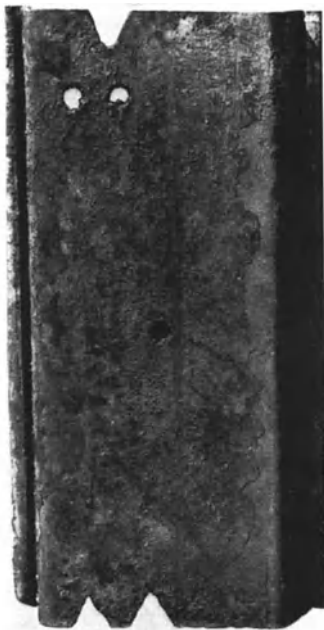
Bild 12. St 3703, Oberseite, nach 2 Jahren ganz im Wasser (Emden)
