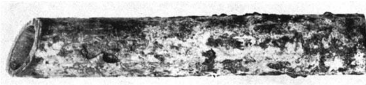
Bild 4. Wasserrohr nach 4 Jahren in feuchtem Gips.
