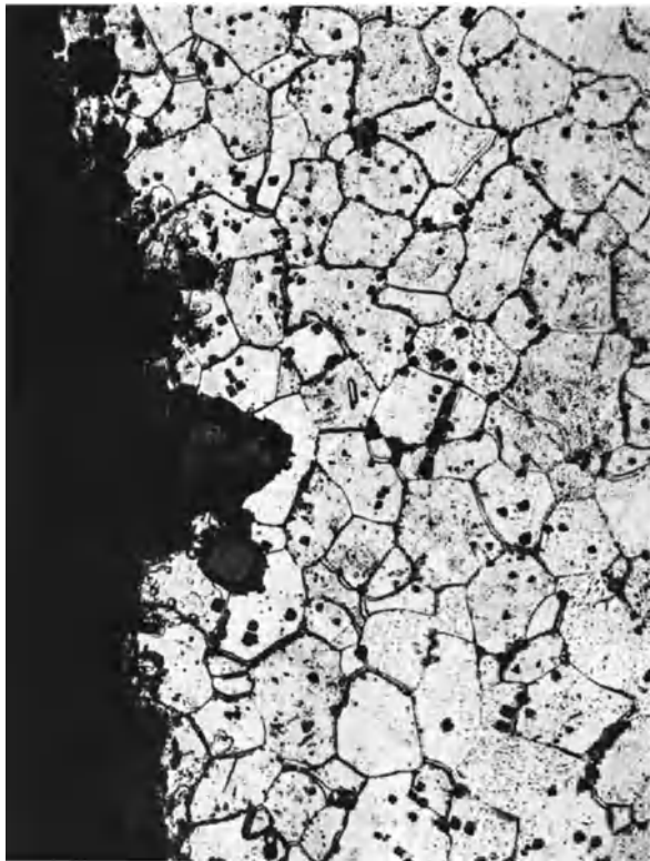
Bild 40. Gefüge des NP 32 bei Anfrassung in Bild 39 * v = \text{lin. Vergrößerung} .
