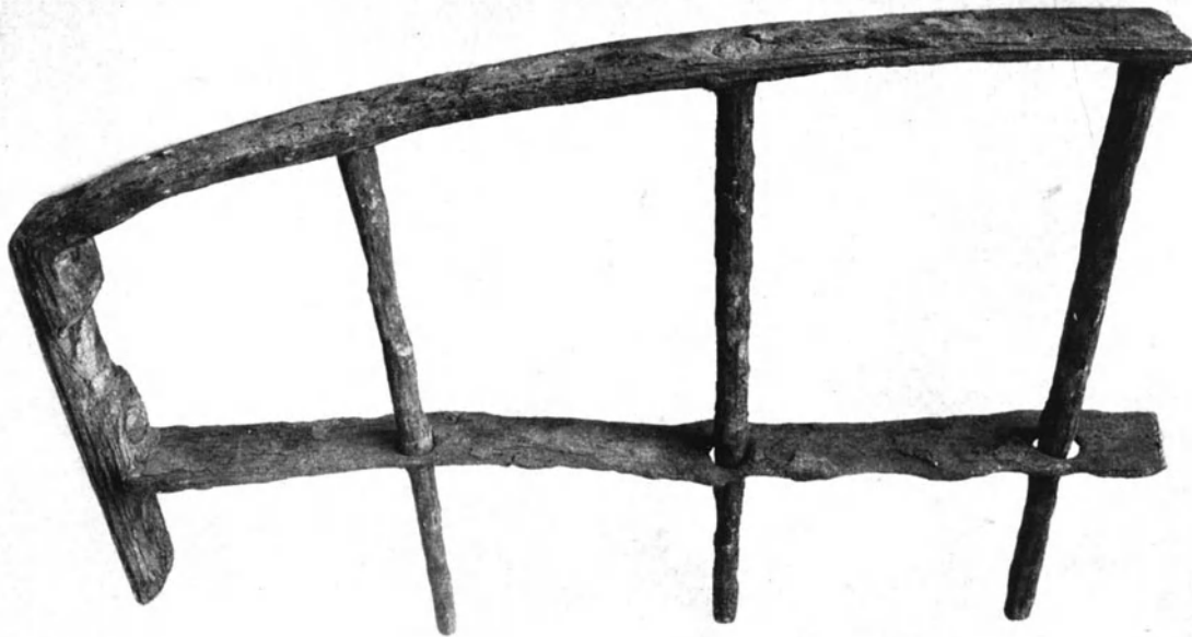
Bild 21. Rostabdeckung (schräg von oben aufgenommen) (Alter 75 Jahre).
