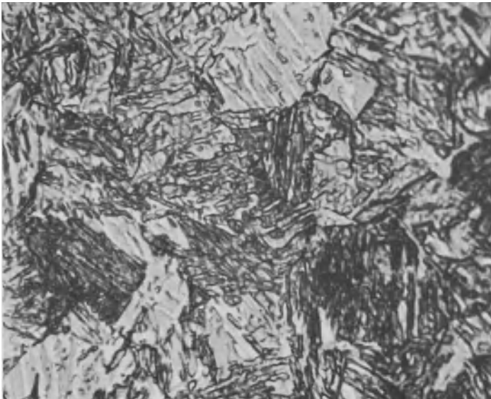
Abb. 132 u. 133. Das Gefüge desselben Stahles ECN 35 wie Abb. 131, aber nach der Wechselbeanspruchung. 2000fach.
