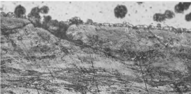
Abb. 14. Längsschliff durch eine Ventiltfeder. Überlappungen durch schlechtes Walzen aus Ursache des Ermüdungsanrisses. 700fach.
