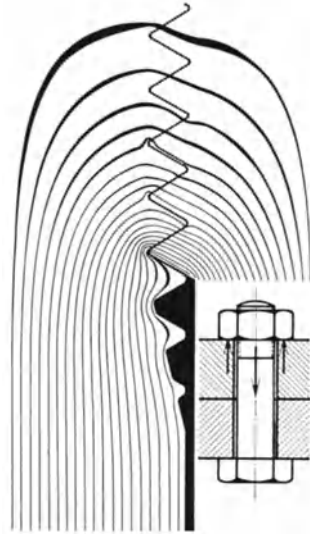
Abb. 146. Kraftlinienverlauf in einer Schraube, aufgenommen mit einem Stromlinienmodell nach Thum.
