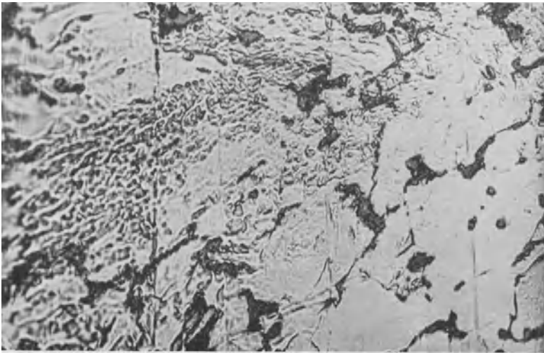
Abb. 9. Kornzerstörungen bei Stahlguß durch Wechselbeanspruchung. 500fach.
