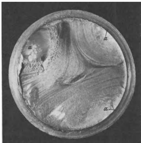
Abb. 20. Biege-Schwingungsbruch einer Differentialwelle aus VCN 35 mit drei Anbruchstellen.
