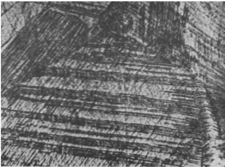
Abb. 5. Gleitebenenbildung in einem 12%igen Manganhartstahl. 2000fach.
