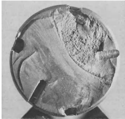
Abb. 21. Biege-Schwingungsbruch einer Differentialwelle, verursacht durch schlechte Montage. (Kerbwirkung durch zahlreiche zu tiefe Anbohrungen.)
