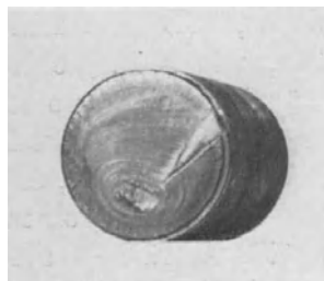
Abb. 19. Ermüdungsbruch einer Welle, verursacht durch rotierende Biegung.
