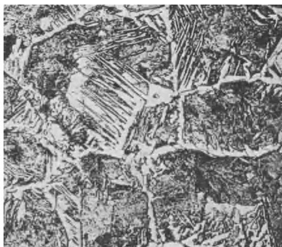
Abb. 135. Das Gefüge desselben Stahles St. C. 35 . 61 wie Abb. 134, aber aus der Zone der autogenen Schweißung. 200fach.
