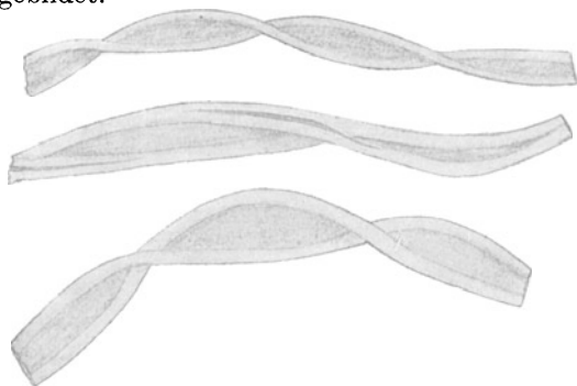
Fig. 188. Baumwollfasern mit den charakteristischen Drehungen. Vergr. 300\times .
