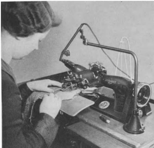
Abb. 73. Klappen mit Pikiermaschine pikieren.
