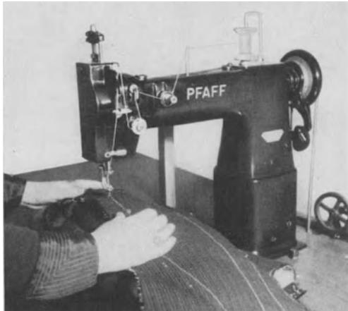
Abb. 72. Wattierung mit der Unterschlagmaschine unterschlagen.
