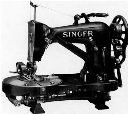
Abb. 33. Knopflochmaschine mit Hand-Einschlaghebel (Singerwerke, Wittenberge).
