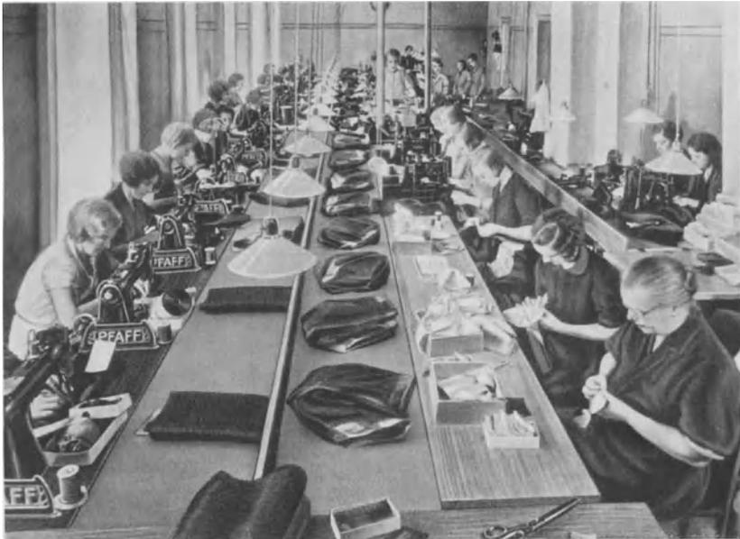
Abb. 65b. Betriebsaufnahme (Hosenfließband mit Vor- und Rückwärtstransport, Reihensystem).
