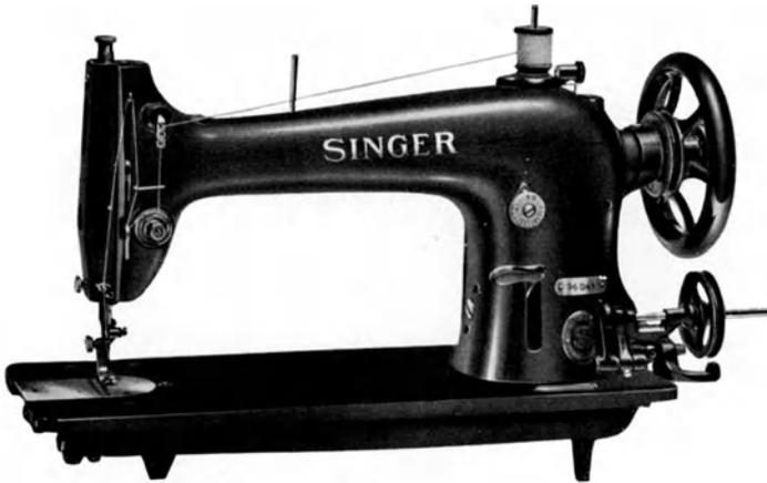
Abb. 19. Maschine mit umlaufendem Greifer (Singerwerke, Wittenberge).
