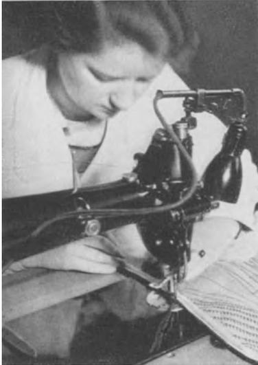
Abb. 76. Kante mit Kantenabschneidemaschine verstürzen.
