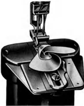
Abb. 24. Stichplatte einer Zweinadel-säulenmaschine mit Doppelkapper (Singerwerke, Wittenberge).
