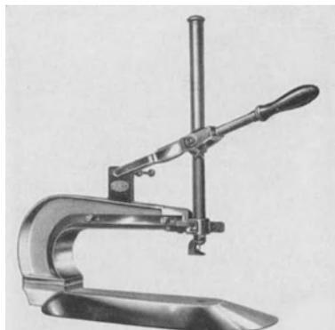
Abb. 12. Fadenmarkiermaschine „Kuris“ (Krauss & Reichert, Stuttgart-Cannstadt).
