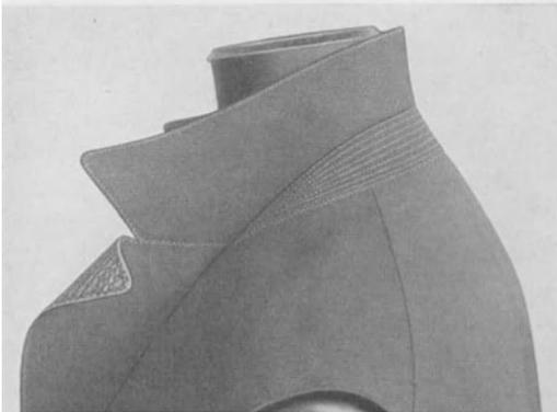
Abb. 56. Mit der Universalmaschine angenähter Unterkragen.
