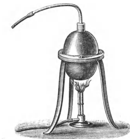
Abb. 407. Kupferretorte zur Sauerstoffgewinnung.
