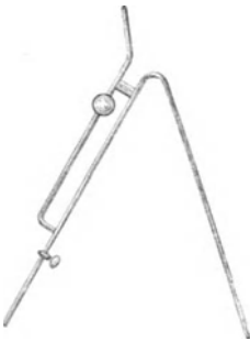
Abb. 12. Heber mit seitlich ange- setztem Saugrohr.
