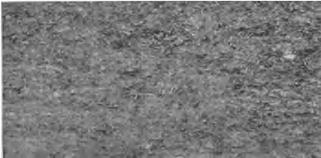
Abb. 30. Schnitt durch eine Torfplatte (Torfoleumplatte) (nat. Größe).
