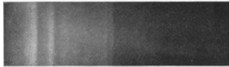
Abb. 84. Magnetisches Spektrum der aus Silber durch die Wolfram - K - Strahlung ausgelösten Elektronen. Nach DE BROGLIE.
