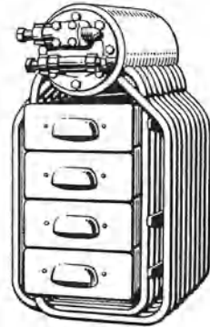
Abb. 11. Verdampfer eines Kompressorkühlschranks.
