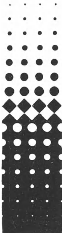
Oberfläche eines Raster-Klischees (Autotypie), vergrößert. Text nebenstehend.
