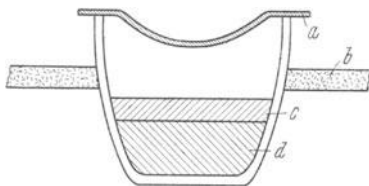
Abb. 11. Tiegel für die Eschka-Methode. a Golddeckel, b Asbestplatte, c Zinkoxyd, d Beschickung.
