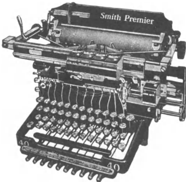
Abb. 6. Rechnende Schreibmaschine mit Schreibwalze: System Smith-Premier.
