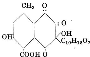
Aus wässriger Carminsäurelösung unter Zusatz von Essigsäure und Mangansuperoxyd in der Kälte: 2 Oxydationsphasen. Zuerst Verschwinden der Carminfarbe; die Lösung ist braungelb und bleibt es auf  $NaOH$ -Zusatz. Durch Reduktion mit  $SO_2$  kehrt die Carminfarbe wieder. Ebenso regeneriert sich Carminsäure beim Stehen oder kurzen Erwärmen. Als Nebenprodukt entsteht wohl ein höher oxydierter Körper, da die Lösung einen mehr braunen stumpfen Farbenton hat.
