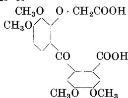
Entsteht durch Abbau des Hämatoxylin-tetramethyläthers (s. oben) durch Oxydation mit Kaliumpermanganat. Farblose Nadeln (aus Eisessig). Schmelzp. 180°. Sehr leicht löslich in heißem Eisessig und Methylalkohol, sehr wenig in Wasser und Benzol; löslich in konz. Schwefelsäure mit rötlichbrauner Farbe. Durch Reduktion mit Natriumamalgam entsteht Dihydrohämatoxylinensäure. Kupfersalz, mattgrün. Sehr wenig löslich.
