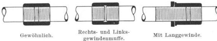
Fig. 101 bis 103. Muffenverbindungen.
