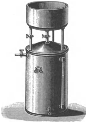
Abb. 9. Gasometer aus Blech.
