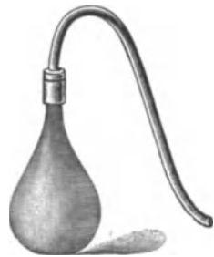
Abb. 8. Retorte zur Gewinnung von Sauerstoff.
