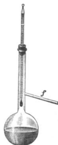
Abb. 47. Fraktionskölbchen für die Siedepunktbestimmung.
