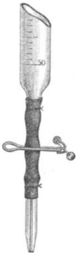
Abb. 74. Verschuß einer Bürette mittelst eines Quetschhahnes.
