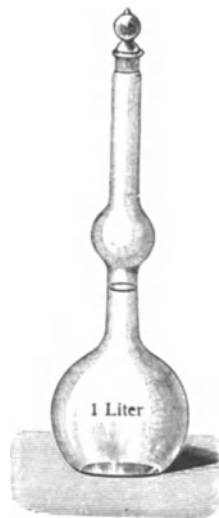
Abb. 90. Maßkolben mit Ausbauchung im Hals.
