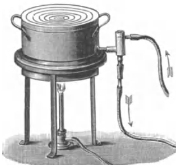
Abb. 4. Wasserbad mit konstantem Wasserniveau.
