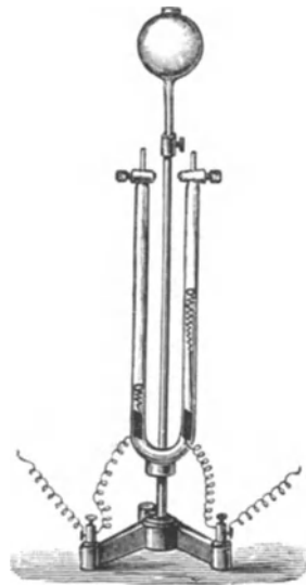
Abb. 7. Vorrichtung zur elektrolytischen Zerlegung des Wassers.
