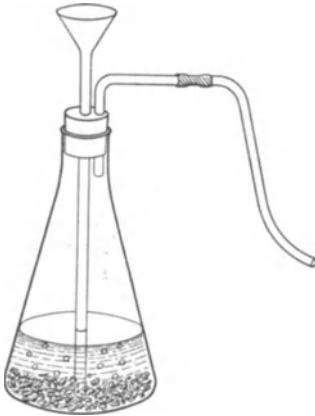
Abb 11. Entwicklung von Wasserstoff durch Zink und verd. Schwefelsäure.
