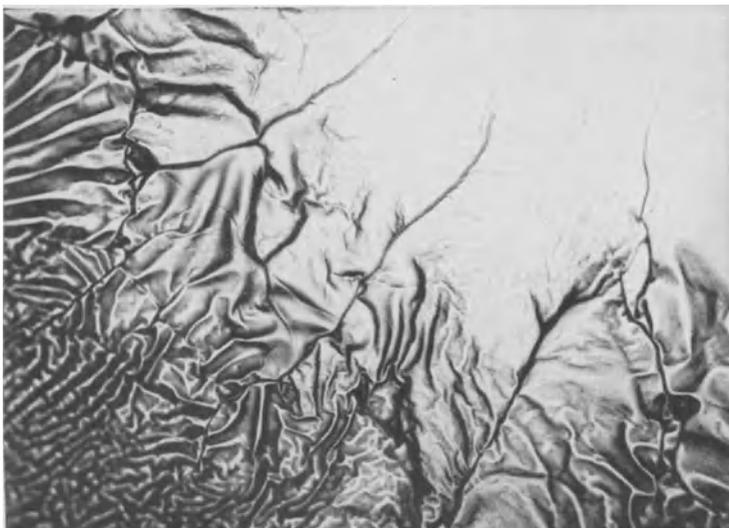
Abb. 24.<sup>3</sup> Faltenbildung bei einem Holzölaufstrich. Die Störungslinien sind keine Risse, sondern Einstülpungen.
