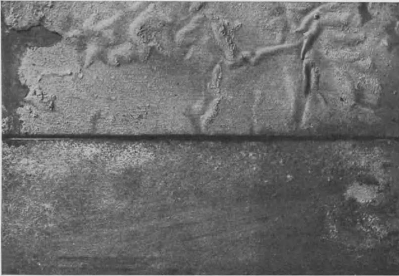
Abb. 157. Grundanstrich Mennige, Deckanstrich Eisenoxydrot. Oben ohne, unten mit Uviollicht bewittert. Starker Unterschied. Platte ohne Uviolbestrahlung stärker verrottet.
