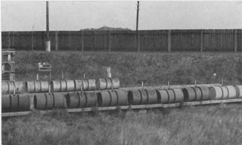
Abb. 140. Versuchsfeld zur Untersuchung der Einwirkung der Sonnenstrahlen auf Anstriche.
