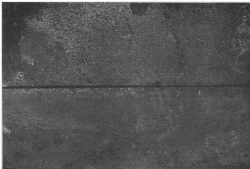
Abb. 159. Grundanstrich Mennige, Deckanstrich Zinkoxyd, Linoleatfirnis. Oben ohne, unten mit Uviollicht bewittert. Geringe Unterschiede. Platte ohne Uviolbestrahlung, um wenig stärker verrottet.
