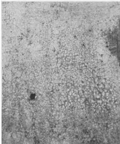
Abb. 120. Mit dem Sandstrahl entrostet. Vor dem Anstrich im Freien gelagert, im Trockenschrank getrocknet.
