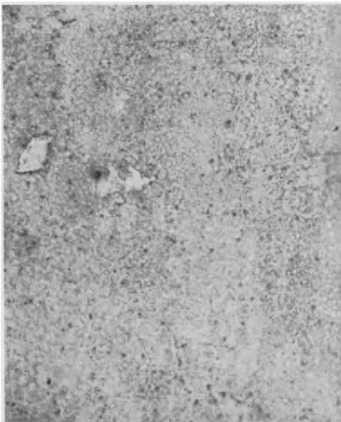
Abb. 118. Mit dem Sandstrahl entrostet. Vor dem Anstrich im Freien gelagert, so gut wie möglich abgetrocknet.
