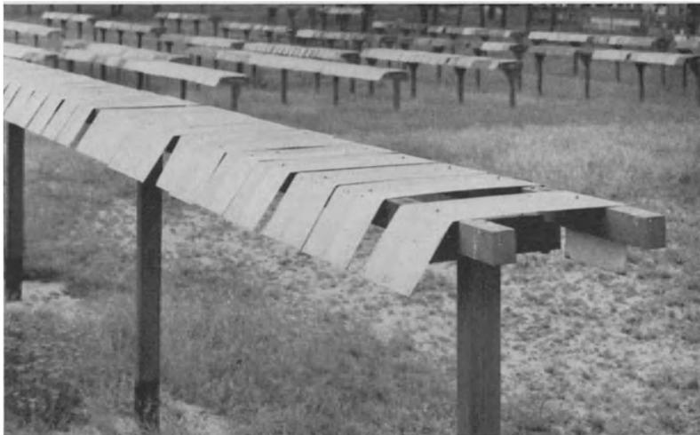
Abb. 154. Prüfgestell am Prüffeld der Deutschen Reichsbahn in Kirchmöser. Form und Befestigung der Probebleche.
