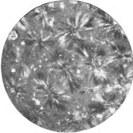
Abb. 34. Falksches Bleiweiß in Leinölsäure nach 18 Stunden. Polarisiertes Licht.  $750\times$ . (Bleiseifenbildung.)
