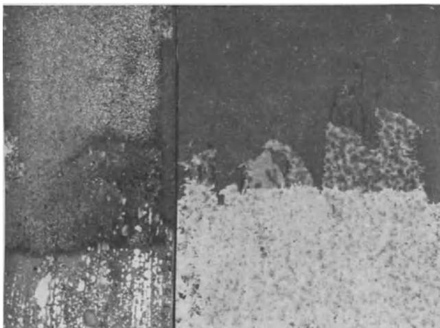
Abb. 135. Eisenrotanstrich 5 (links Kurzprüfapparat, rechts Werkskanal).
