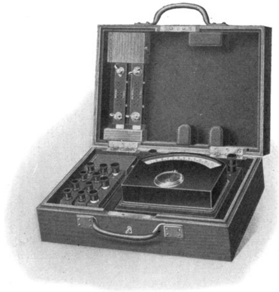
Zehnohm-Instrument nebst Zubehör für Strommessungen.
