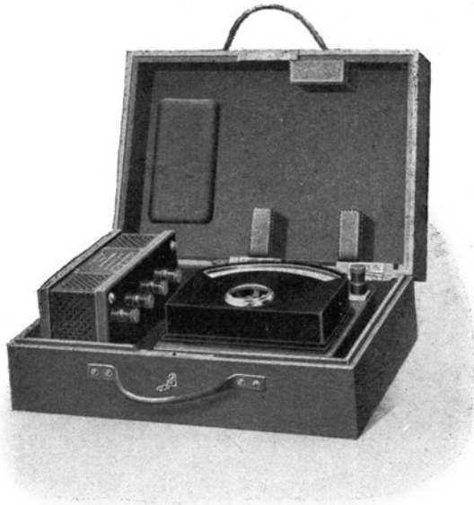
Zehnmeter-Instrument nebst Zubehör für Spannungsmessungen.
