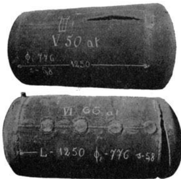
Abb. 39 und 40. Probebehälter V und VI, autogen geschweißt von Edward King's Erben, Zürich-Wollishofen.
