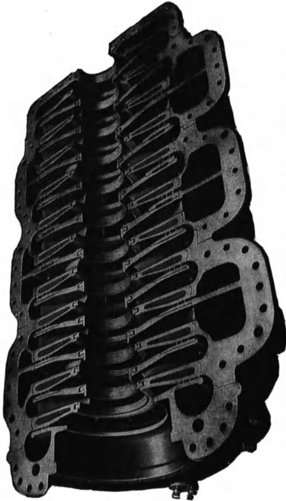
Abb. 197. Obere Gehäusehälfte eines Stahlwerkgebläses von British Thomson-Houston Co. Ltd
