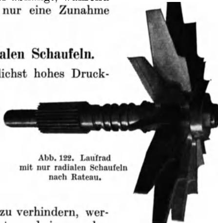
Abb. 122. Laufrad mit nur radialen Schaufeln nach Rateau.
