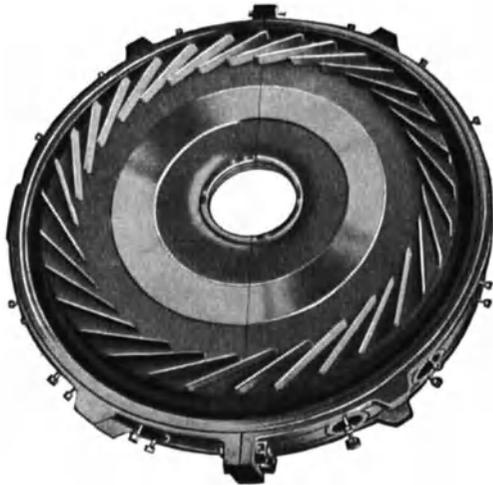
Abb. 202. Gehäuseelement für innengekühlte Maschinen.
