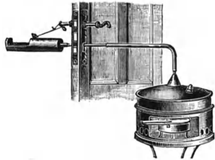
Abb. 156. Ammoniakverdampfungsapparat. (Nach FLÜGGE.)
