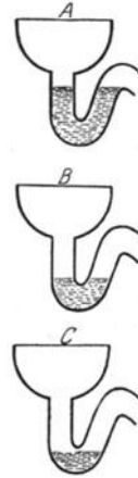
Abb. 94. Verschiedene Füllungen der Syphons. A normaler, gefüllter Syphon. B geschwächter Syphon. C leer gezogener Syphon.
