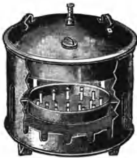
Abb. 155. Formaldehydverdampfungsapparat. (Nach FLÜGGE.)
