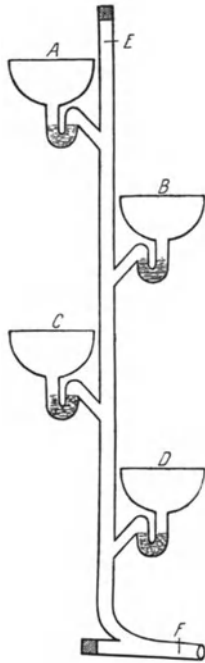
Abb. 93. Schema der Ausgüsse und Syphons eines Hauses.
