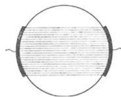
Fig. 53. Stromlinien bei richtiger Größe und Lage der Elektroden.
