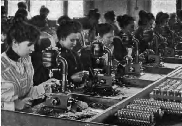
Fig. 175. Kleine Vertikal-Bohrmaschinen, Gleichstrom.
