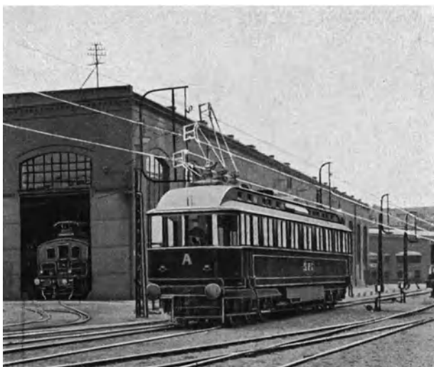
Fig. 243. Motorwagen für elektrische Schnellbahnen. Drehstrom 12 000 Volt.
