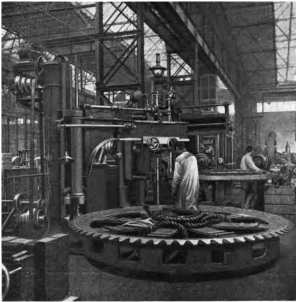
Fig. 178. Grosse Radial-Bohrmaschine, Drehstrom.
