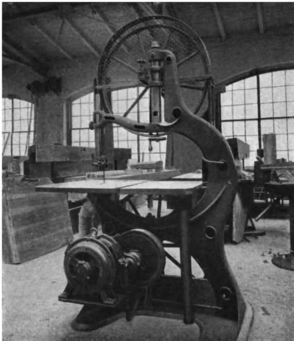
Fig. 184. Bandsäge für Tischlereien, Drehstrom.
