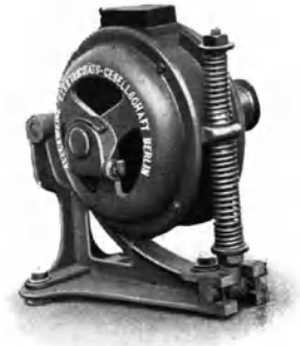
Fig. 137. Motor mit Riemenschwinge.
