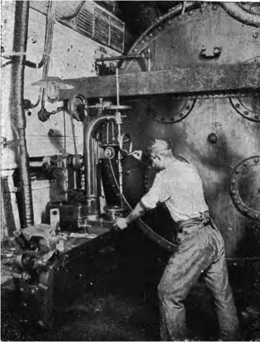
Fig. 226. Transportable Bohrmaschine für Schiffsräume, Gleichstrom.
