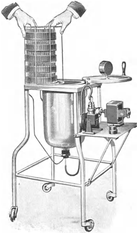
Abb. 118. Elektrisch betriebener Ampullenfüllapparat der Firma Pneumotechnik. Gestell mit Ampullenschalen wird eingesetzt.
