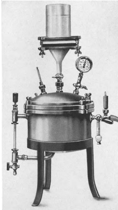
Abb. 117. Apparat zur Reinigung und sterilen Füllung von Ampullen. Jenaer Universal-Apparat D. R. P. mit Keimfilter nach Prof. Dr. ZSIGMONDY. (E. Koellner, Jena.)
