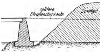
Abb. 111. Vorbelastung des Untergrundes.
