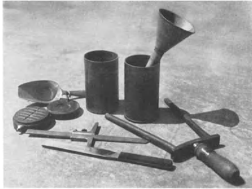
Abb. 34. Gerät für den Einrüttelungsversuch.
