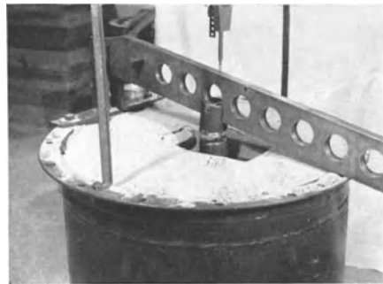
Abb. 41. Modellversuch mit Platten verschiedener Form auf Sand.
