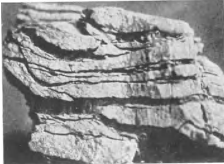
Abb. 90. Eisschichten im Boden.
