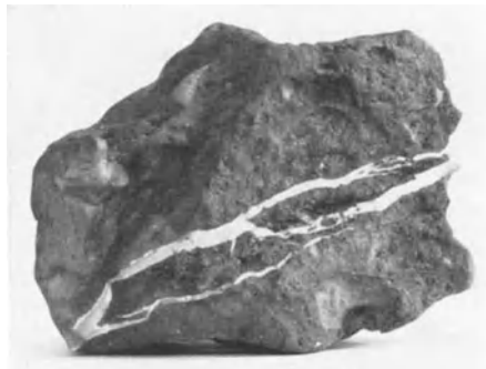
Abb. 157. Mit Zement injizierte Bodenprobe.
