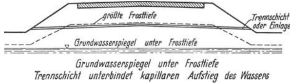
Abb. 100. Trennschicht im Auftrag.
