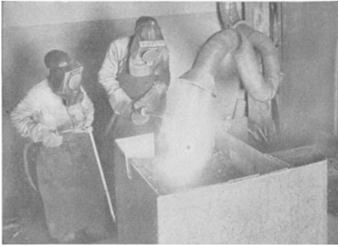
Abb. 319. Elektrische Warmschweißung eines Maschinenständers.
