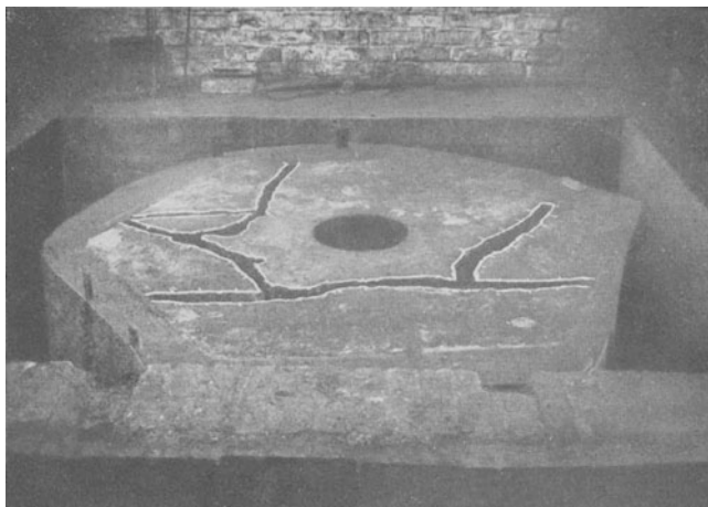
Abb. 326. Zur Warmschweißung vorbereitete Ständerplatte.
