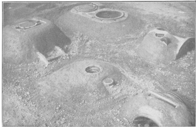
Abb. 321. Zur Wärmeschweißung vorbereitete Gußstücke.
