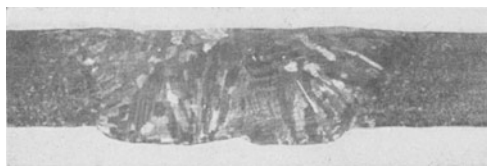
Abb. 339. Makroschliff einer elektrischen Aluminiumbronzeschweißung.
