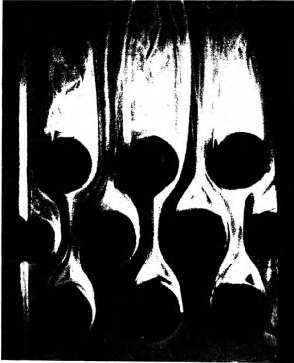
Abb. 3. Luftströmung im Modell eines Heizapparates.
