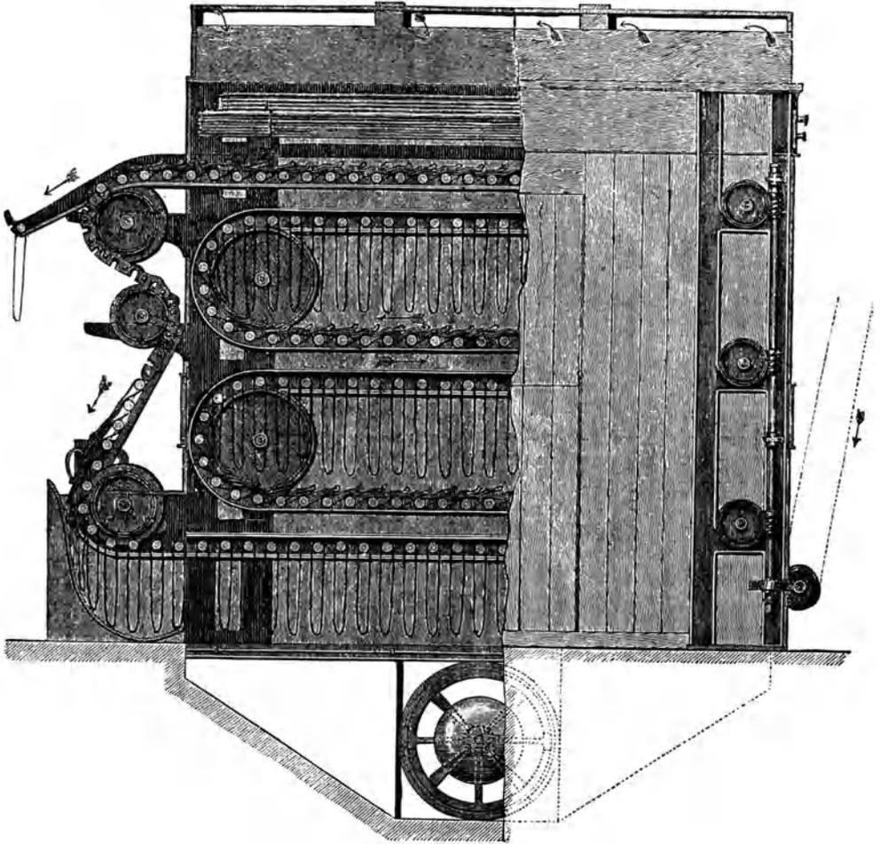
Fig. 52. Trockenmaschine von Gebr. Sulzer in Winterthur.
