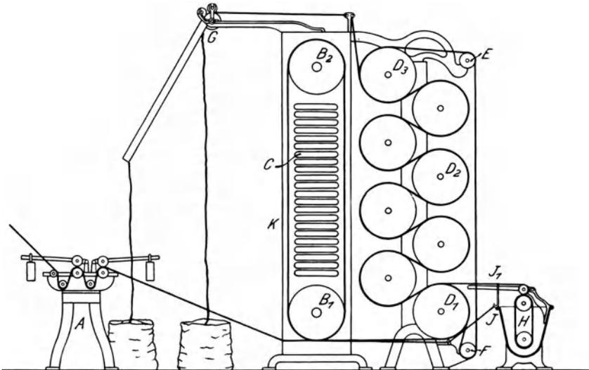
Fig. 48. Kettenfärbemaschine nach J. W. Fries.
