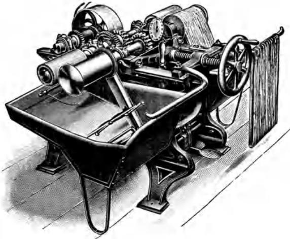
Fig. 23. Passiermaschine von J. Timmer in Koesfeld.
