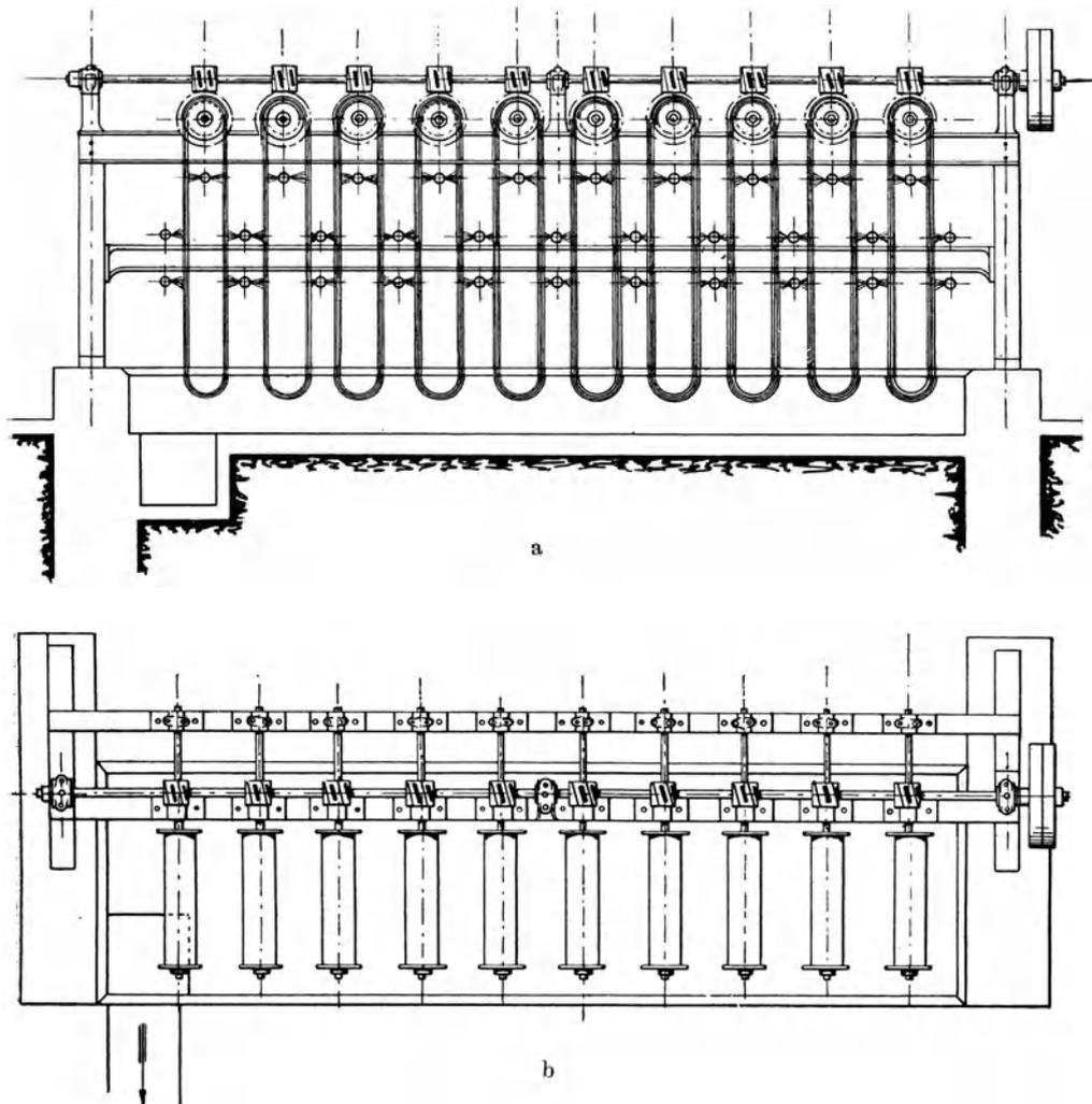
Fig. 49. Stranggarn-Waschmaschine der Zittauer Maschinen-Fabrik.
