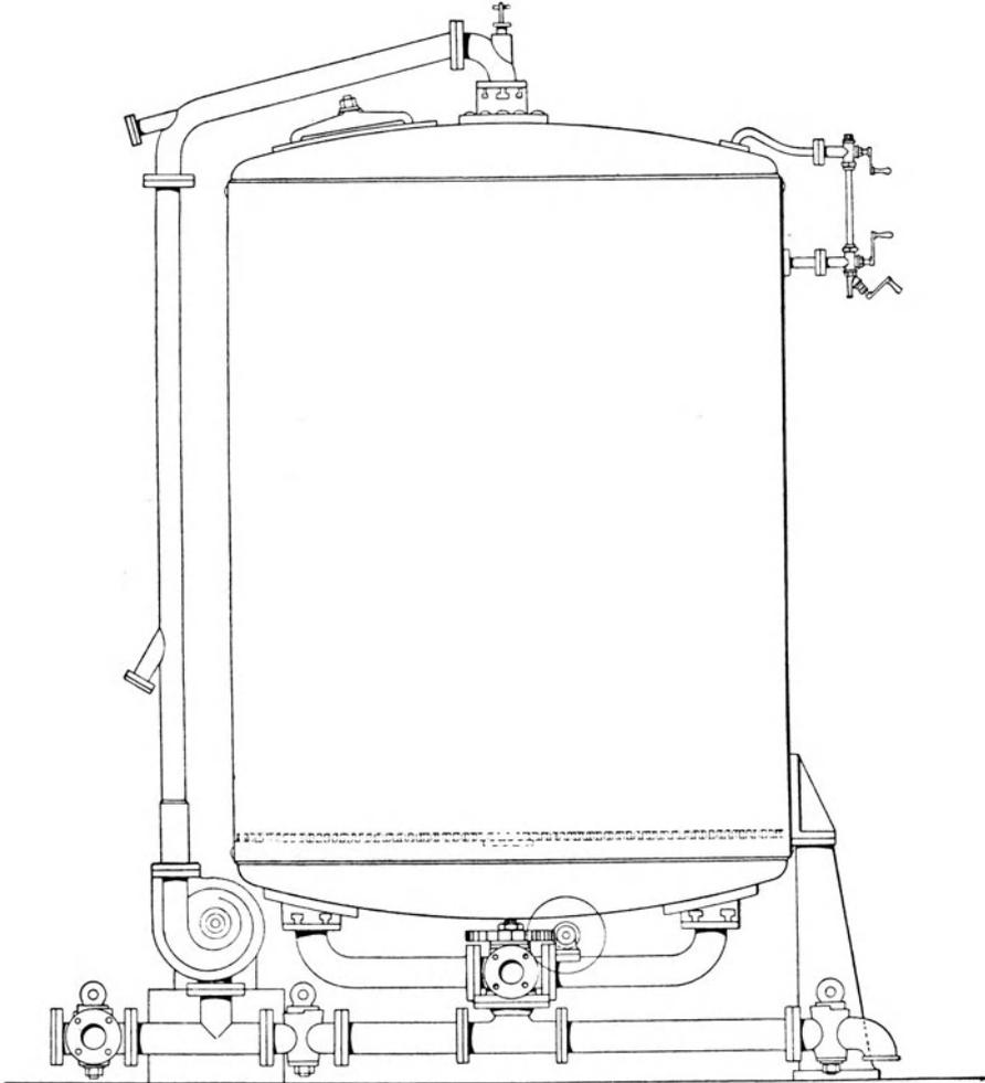
Fig. 1. Kochkessel nach System Erban-Pick (Zittauer Maschinen-Fabrik).
