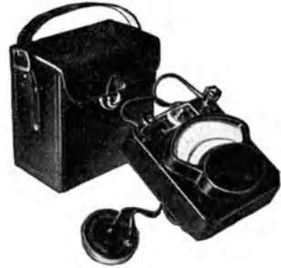
Abb. 44. Lichtelektrischer Beleuchtungsmesser nach B. LANGE.
