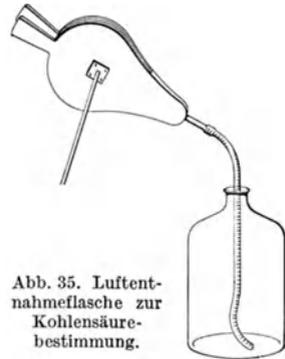
Abb. 35. Luftentnahmeflasche zur Kohlensäurebestimmung.
