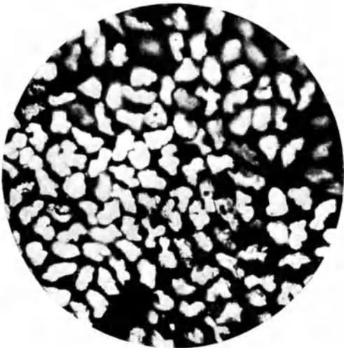
Abb. 104. Mikroskopisches Bild einer Acetatzellwolle, (Querschnitt). (Aus BODENBENDER, S. 194.)
