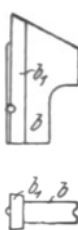
Bild 328 u. 329. Einsatzzahn mit auf den Zahnkörper aufgelöteter Schnellschnittstahl-Brust; Joh. Wilh. Arntz, Remscheid.
