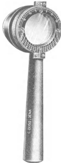
HERSCHELSches Doppelprisma mit LANDOLTScher Teilung nach C. ZEISS.
