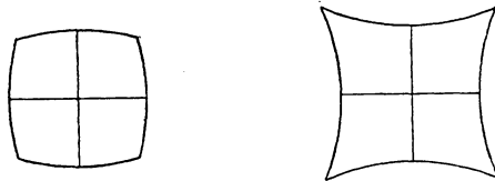
Übersichtsbild der Erscheinungsform der tonnenförmigen Verzeichnung für ein Quadrat kissenförmigen Verzeichnung für ein Quadrat.
