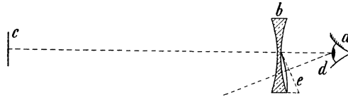
Achsenschnitt durch ein Brillenglas mit Nachsteckglas nach A. WOLFF.
