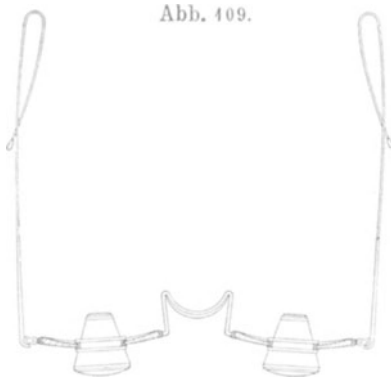
ZEISSISCHE Brillenlupe für Fehlsichtige. Das in zweifacher Vergrößerung wiedergegebene Nahgebiet wird von dem nicht vergrößerten Ferngebiet ringartig umfaßt.
