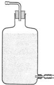
Abb. 4. Flasche mit abgerundetem Boden für Trockenmittel (Kieselgel).
