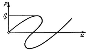
Abb. 5. In  $P$  und  $u$  mehrdeutiges  $(P, u)$ -Diagramm.
