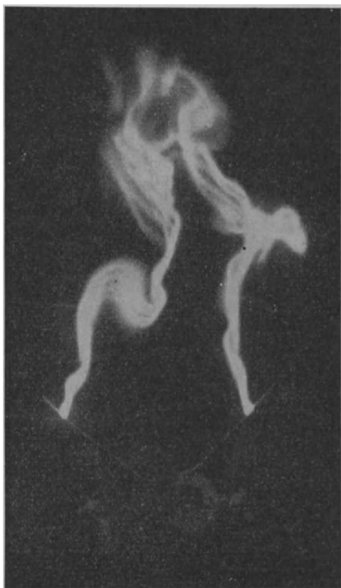
Abb. 99. Lichtbogen einer Hörnerblitzschutzvorrichtung kurz vor dem Verlöschen.
