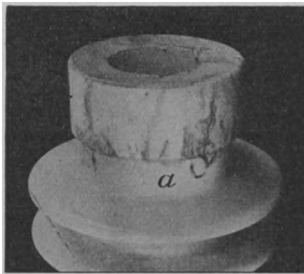
Abb. 509. Angriff (Ausbröckelung) des Porzellans durch gleitende Entladungen unter Öl.
