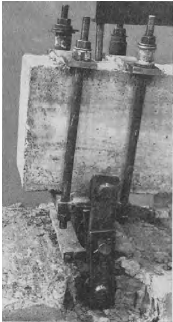
Abb. 28. Bewegliches Lager nach dem Versuch.
