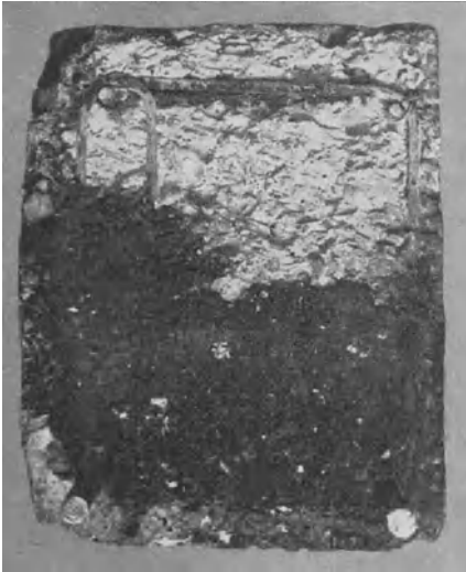
Abb. 23. Balken 54 a, Riß 4 (nach dem Bruch gefärbt).
