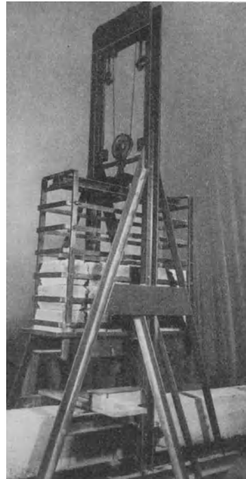
Abb. 32. Anordnung zum Aufzeichnen der Bewegung des großen Fallgewichtes.
