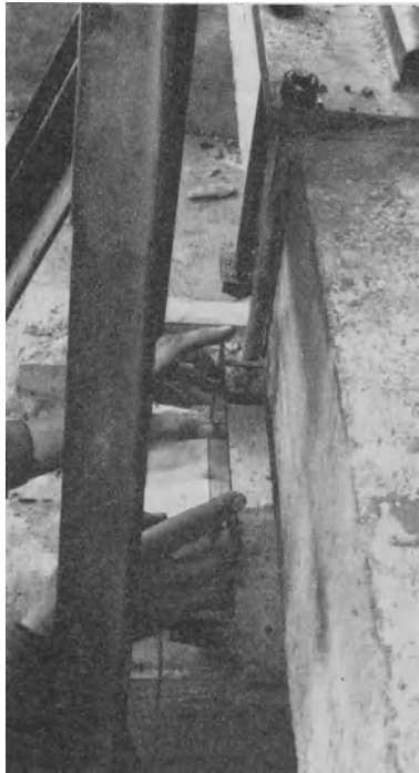
Abb. 31. Aufzeichnung der Balkenschwingungen.
