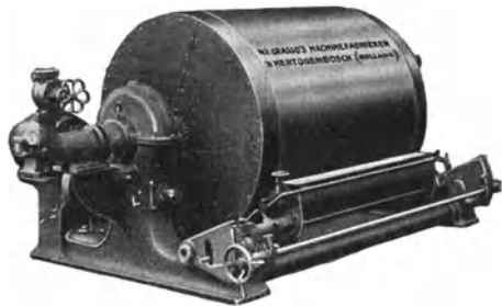
Abb. 133. Kühlwalze mit unmittelbarer Verdampfung (Grasso).
