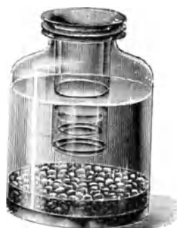
Fig. 70. Entwässerungsgefäß nach F. E. Schulze.
