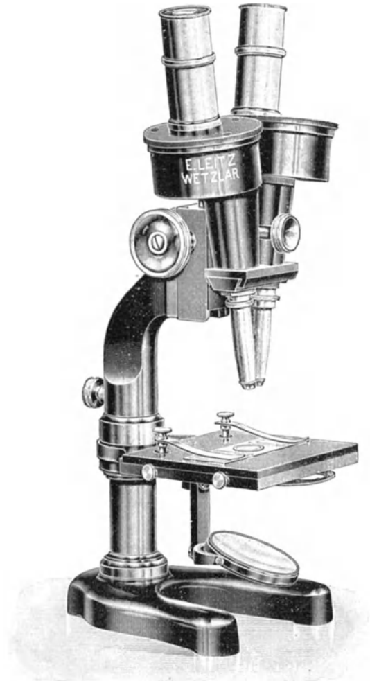
Fig. 39. Stereoskopisches Binokular-Mikroskop nach Grenough.
