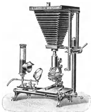
Fig. 52. Mikrophotographischer Apparat II in aufrechter Stellung.
