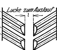
Abb. 53. Mit Scheibenfräsern gefräste Pfeilzähne
