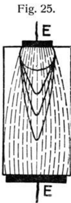
Wärmezonen bei gleich großen Elektroden.
