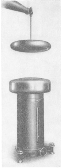
Abb. 80/8. Elektrostat. Voltmeter für 1000 kV mit Fernanzeige (Trüb, Täuber).
