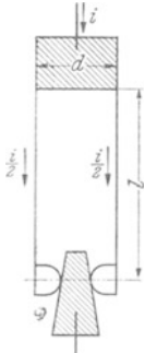
Abb. 95/5. Dynamische Kontaktfinger (Delle).
