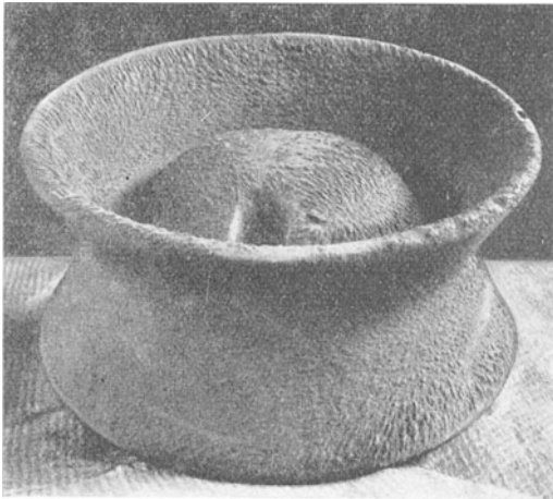
Abb. 57/1. Glied einer Hängeisolatorenkette, im Betrieb mit Zementstaub beschlagen (SSW).
