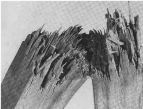
Abb. 114. Statischer Biegebruch von Esche.
