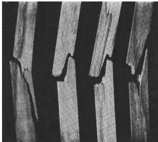
Abb. 100. Schlagbiegebrüche an Proben niedriger Schlagfestigkeit a (Stamm 247).
