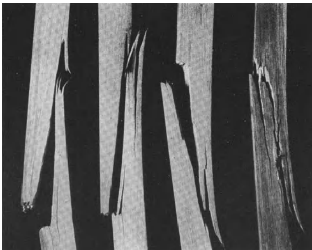
Abb. 101. Schlagbiegebrüche an Proben desselben Stammes (Nr. 247) mit guter Schlagfestigkeit.
