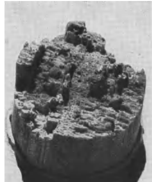
Abb. 115. Dauerbiegebruch von Esche.
