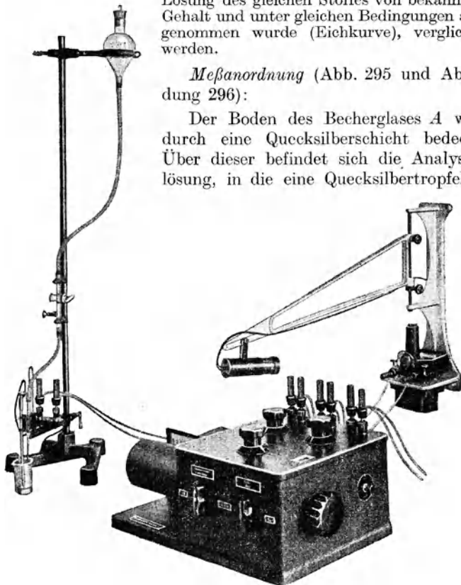
Abb. 296. Ansicht der Meßanordnung eines Polarographen (Leybold, Köln-Bayental).
