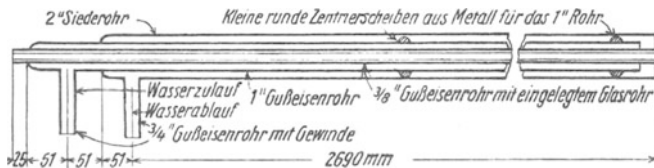
Fig. 2. Wassergekühltes Entnahmerohr für Gase.
