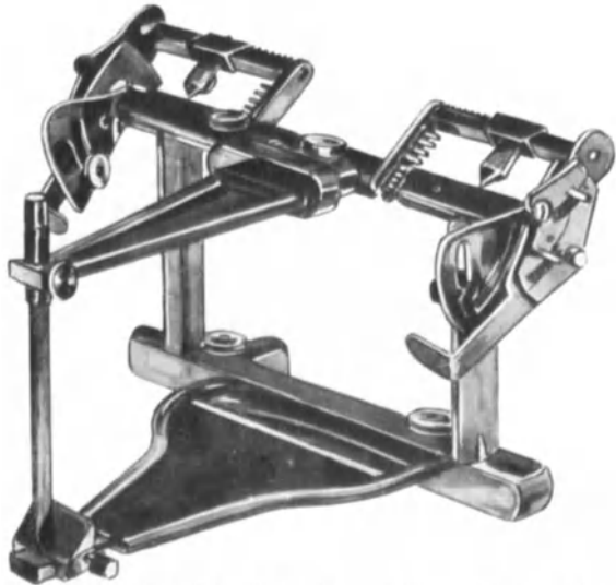
Abb. 654. Gysi-Artikulator mit verstellbaren Wippunkten. (Nach MÜLLER: Artikulationsproblem.)
