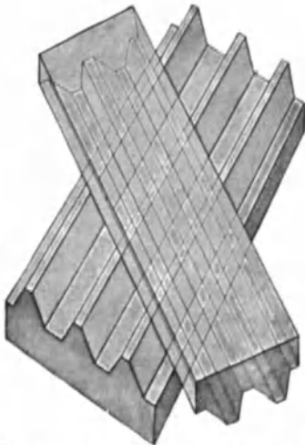
Abb. 148a. Schematische Darstellung der gegenseitigen Wirkung der Keilleisten auf der Kaufläche der Anatoformmolaren. Die kreuzweise Lagerung sichert ein ruhiges Übereinandergleiten und große Schneidwirkung bei minimalem Kaudruck.
