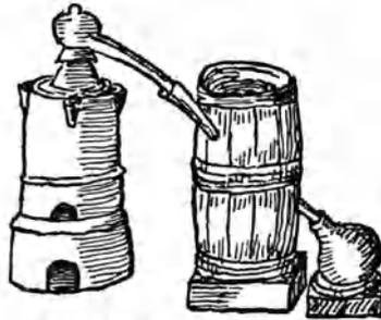
Abb. 2. Alter Destillier-Apparat mit Wasser-Kühler.
