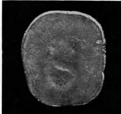
b) Überzug von Lardöl. Glatte untere Fläche und verhältnismäßige Freiheit von Oxydation.
