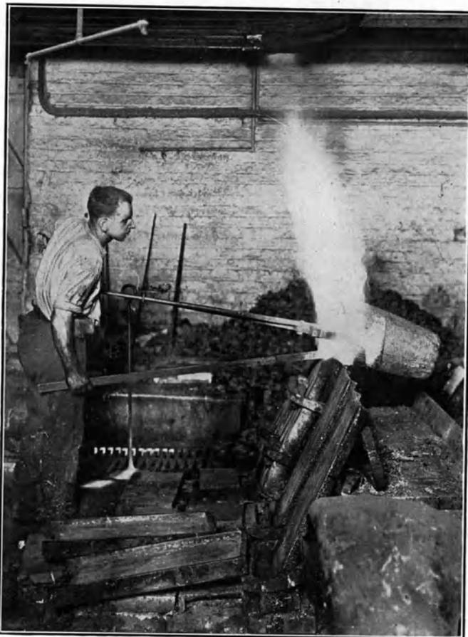
Abb. 5. Gießen eines Messingblockes im Tiegelgußverfahren.
