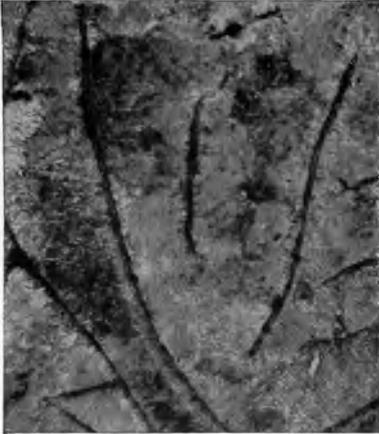
Abb. 70. Kennzeichnendes Gefüge von normalem, grauem Gußeisen.  $\times 250$ .
