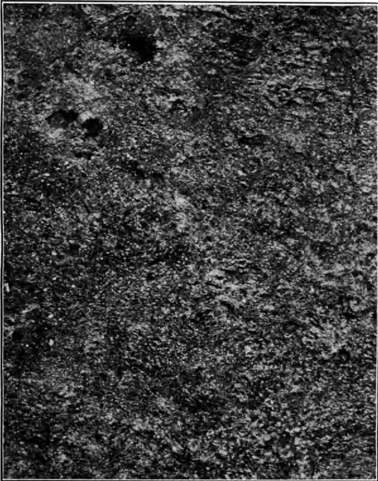
Abb. 7. Oberfläche eines bei niedriger Temperatur gegossenen Blockes. (Block H, Abb. 8)  $\times 2$ .
