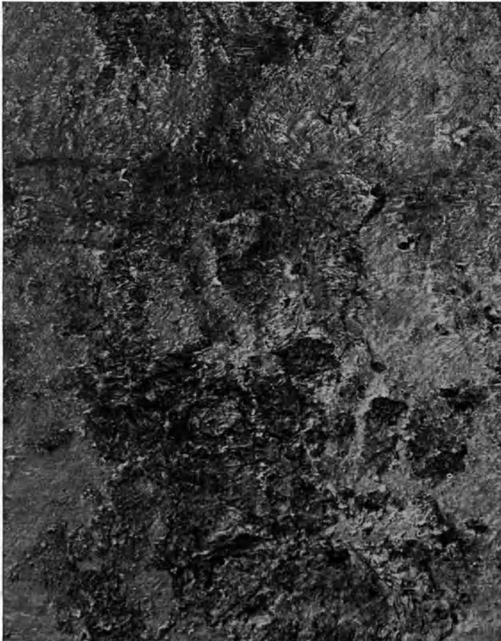
Abb. 30. Fehlstellen in der Oberfläche eines Messingblockes, durch Oxydhaut hervorgerufen.  $\times 2$ .
