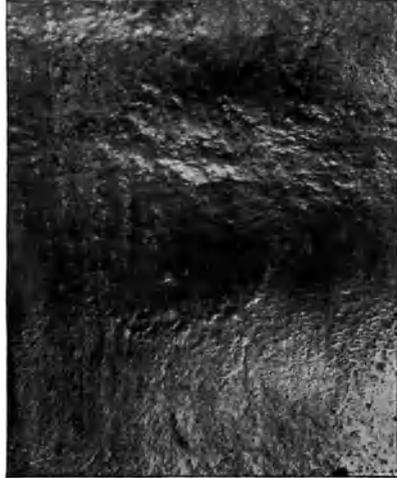
Abb. 42. Innenfläche eines „ausgelaufenen“ Blockes von 70/30 Messing. Natürliche Größe.
