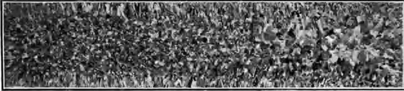
Abb. 89. Gefüge von 70/30 Messing mit 0,2% Aluminium im Durvilleverfahren bei 980° C und rascher Schwenkung gegossen. Natürliche Größe.
