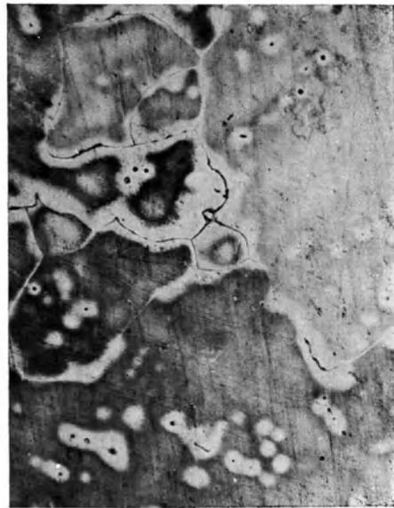
Abb. 120. Kleingefüge von 70/30 Messing mit 0,09 % Phosphor. Gußzustand.  $\times 100$ .
