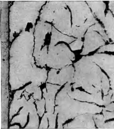
Abb. 72. Rand des in Abb. 71 gezeigten Zylinders, stellt die Entkohlung des Perlits dar.  $\times 250$ .
