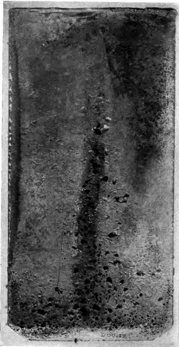
Abb. 68. In gußeiserner Form bei einer Anfangstemperatur von 300° C. gegossener Block der ausgedehnte Blasstellen („blowing“) aufweist.
