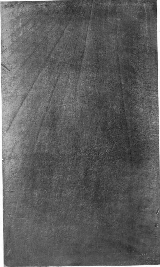
Abb. 87. Oberfläche eines nach dem Durvilleverfahren gegossenen 91/9 Aluminiumbronzeblockes.
