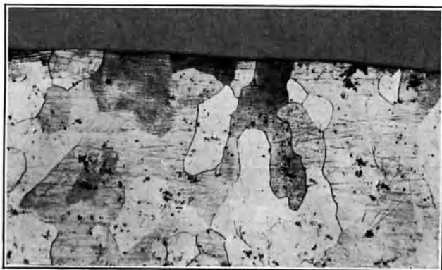
Abb. 92. Kleingefüge in der Oberflächenschicht des in Abb. 90 dargestellten Blockes.
