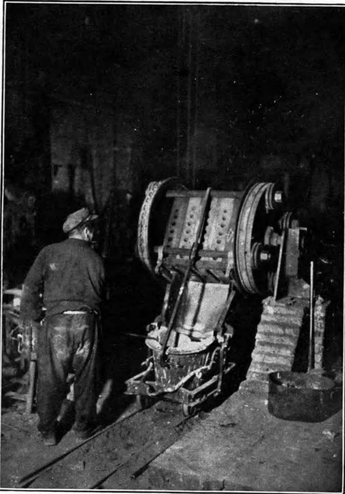
Abb. 84. Die Original-Durvillemaschine, die Pfanne fertig zum Schwenken angebracht.
