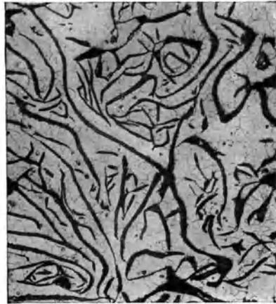
Abb. 73. Gefüge eines Musterbeispiels von nichtperlitischem Gußeisen.  $\times 100$ .
