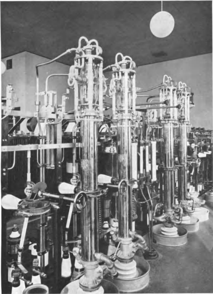
Abb. 51. Die siebente Stufe des Wiener Großsenders (zwei 300-Kilowatt- röhren für Betrieb und zwei als Reserve). (Phot. Martin Gerlach.)
