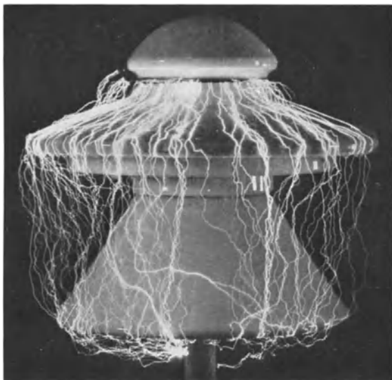
Abb. 39. Überschlag (Funkenentladung) an einem Isolator. (Aus Benischke, G.: Grundlagen der Elektrotechnik. 6. Aufl. Berlin: Julius Springer 1922.)
