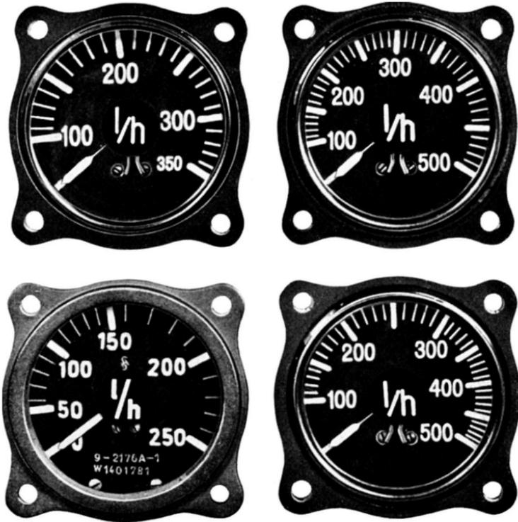
Abb. 132. Verbrauchsanzeiger für Flugmotore
