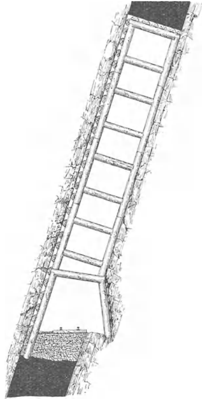
Fig. 38. Schalholzzimmerung mit Fußklemmen beim Pfeilerbau.
