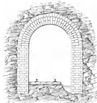
Fig. 99. Scheibenmauern (1 1/2 Stein stark) mit Halbkreisgewölbe.
