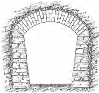
Fig. 98. Geböschte Scheibenmauern aus Bruchsteinen mit Ziegel-Gewölbekappen.
