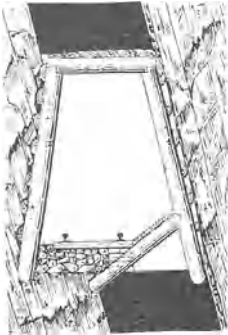
Fig. 28. Türstock mit abgedeckter Wasserseige.
