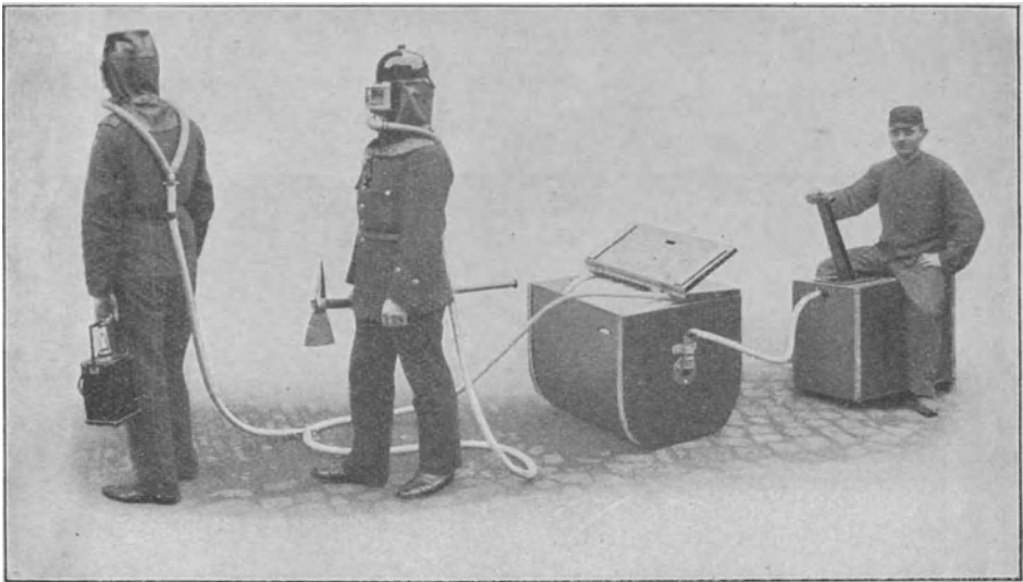
Fig. 583. Königsche Druckschlauch-Atmungsgeräte für Nasenatmung, nebst Luftschlauch und Blasebalg.
