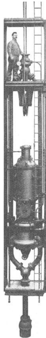
Fig. 569. Vierstufige Zentrifugalpumpe für Abteufzwecke in der Ausführung der Firma Gebr. Sulzer zu Winterthur (Leistung 3 cbm minutlich bei 200 m Druckhöhe).
