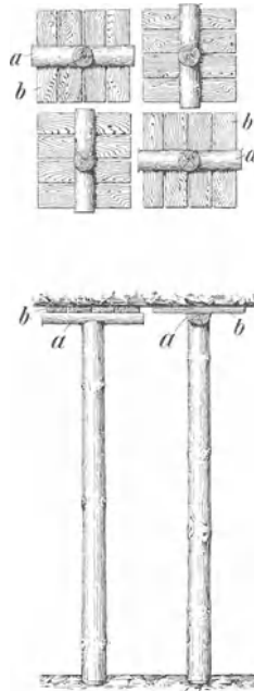
Fig. 8. Stempelausbau im deutschen Braunkohlenbruchbau.
