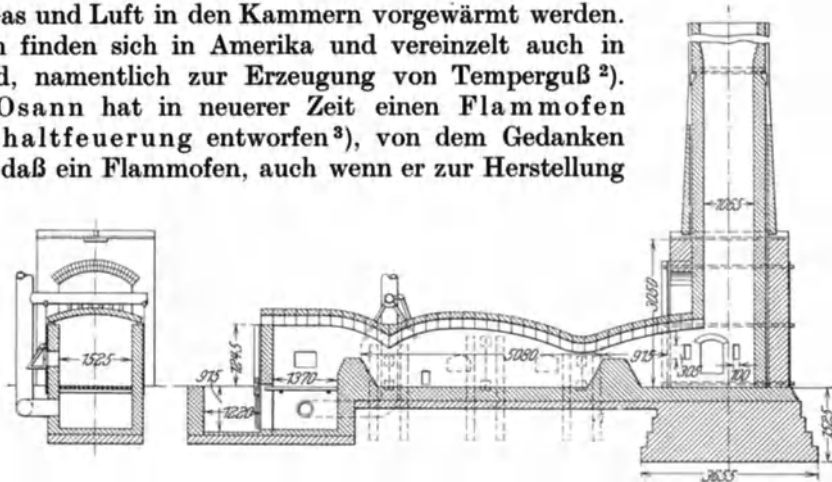
Abb. 216. Amerikanischer Gießereiflammofen mit Unterwind.
