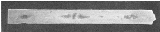
Abb. 404. Lunkerstellen in einem Probestab.
