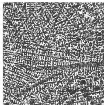
Abb. 612. Stahlguß mit dendritischer Anordnung von Ferrit und Perlit. Vergr. 50.
