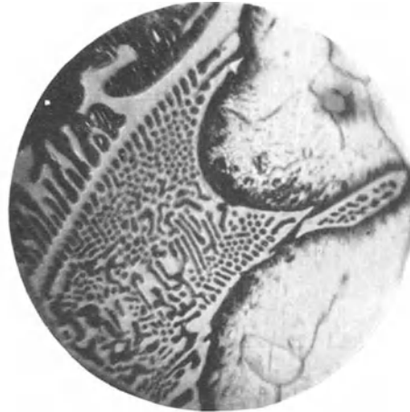
Abb. 657. Zersetztes Eisenphosphid-Eutektikum. Vergr. 750.
