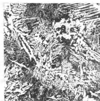
Abb. 576. Desgleichen. Ferrit IV. Vergr. 50.
