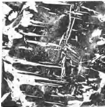
Abb. 590. Stahlguß mit 0,4% C, ungeglöh­. Vergr. 100.
