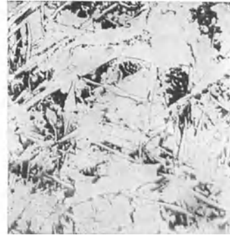
Abb. 585. Stahlguß mit 0,27% C, bei 800° geglüht. Vergr. 80.
