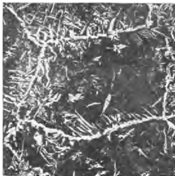
Abb. 575. Desgleichen. Ferrit III. Vergr. 50.
