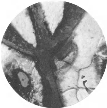
Abb. 656. Oxydiertes Gußeisen. Vergr. 750.
