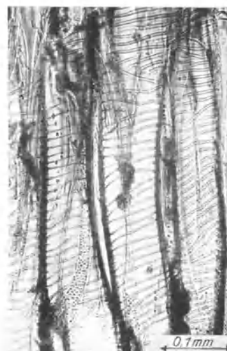
Abb. 756. Längsschnitt durch Lindenholz. Vergr. 150.
