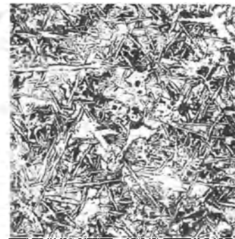
Abb. 591. Stahlguß mit 0,4% C, bei 730^{\circ} geg­löh­. Vergr. 100.
